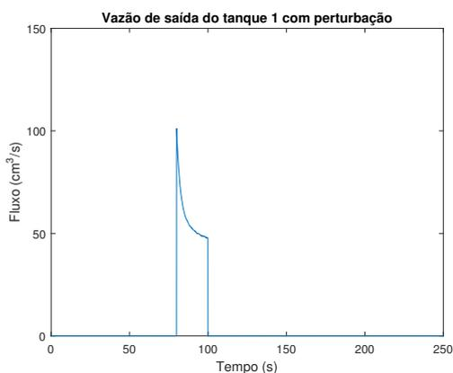
(d) Saída do tanque 1 para falha ocorrida na válvula  $k_1$ .
