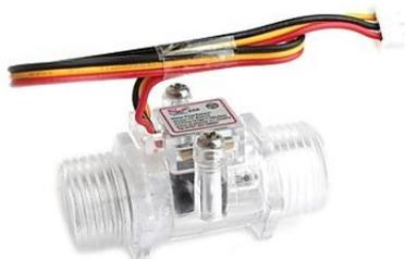
Figura 3.5: Sensor YF-S201C
