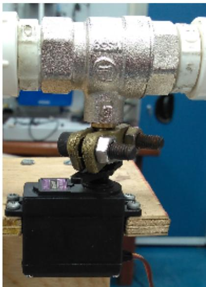
Figura 3.15: Resultado da construção da servo válvula.
