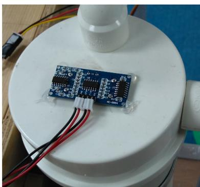
Figura 3.11: Sensor ultrassônico inserido no tanque.
