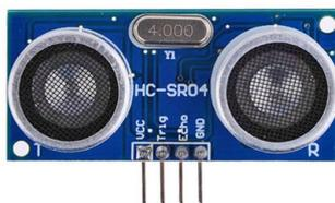
Figura 3.4: Sensor ultrassônico HC-SR04
